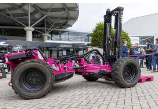
Per 5G gesteuerter, autonom fahrender Gabelstapler der Telekom.
