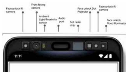
Auf einen Notch verzichtet Google. Der obere Rand des Pixel-Phones ist vollgepackt mit Sensoren, Chips und Kameras.
