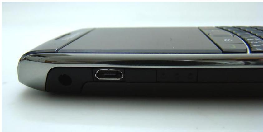
Schnittstelle: Strom und Daten gelangen nun über die Micro-USB-Schnittstelle auf das Gerät.
