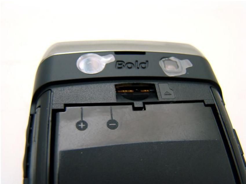
Speicherplatz: Die MicroSD-Speicherkarte wird schräg über dem Akku eingeschoben.
